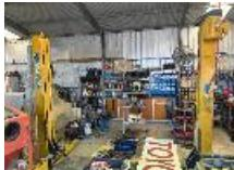
2 POST VEHICLE HOIST, TECALEMIT<br>MOD: TEC3000<br>S/NO: 7228<br>3,000kg CAPACITY<br>415V |      |
